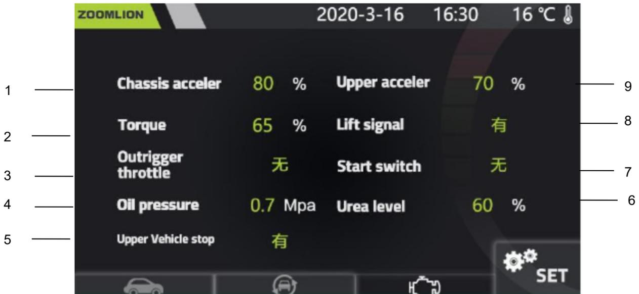
Figure 3-11 3<sup>rd</sup> instrument interface
